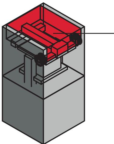
Podnoszona kłapa zasłaniająca część mechaniczną
