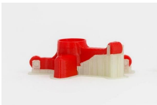
Rys. 3 Model wydrukowany z materiału modelowego PLA i materiału podporowego BVOH
