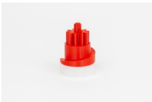
Rys. 1 Model wydrukowany z materiału modelowego ABS i materiału podporowego HIPS
