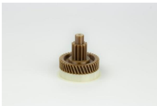
Rys. 4 Model wydrukowany z materiału modelowego PEEK i materiału podporowego ESM-10
