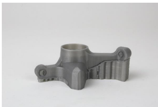
Rys. 2 Model wydrukowany z materiału modelowego PLA i materiału podporowego PLA
