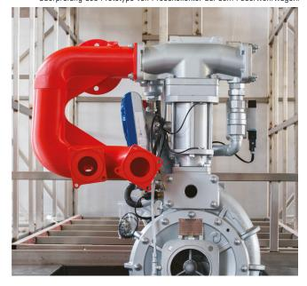
Die Verwendung von 3DGence INDUSRY F340 ermöglichte die Überprüfung des Prototyps von Presskollektor, der eines der Elemente ist, aus dem die Hydraulikpumpeneinheit des Feuerwehrwagens besteht. Der fertige Abguss solches Korrektors soll das manuelle Schweißen von Kniestücken, Rohren und Flanschen ersetzen. Das Erreichen viel besserer Genauigkeit und der Wiederholbarkeit der hergestellten Hydraulik, was die geringere Störanfälligkeit dieser Einheiten mit sich bringt.
