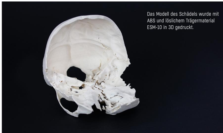
Das Modell des Schädels wurde mit ABS und löslichem Trägermaterial ESM-10 in 3D gedruckt.
